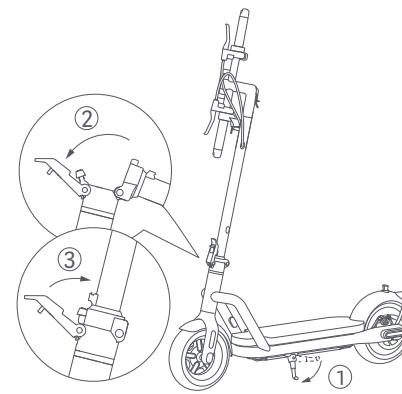
1. Sortez la trottinette du carton et la poser sur un sol stable et plat. Dressez complètement la colonne verticale en position droite, soulevez le verrouillage de sécurité et poussez la poignée de pliage à fond vers l'intérieur. Déployez ensuite la béquille.
