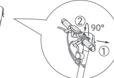
La trottinette DOIT être éteinte avant d'être pliée. Tenez le guidon, appuyez sur le verrouillage de sécurité et tirez le levier de libération rapide. Tournez ensuite le guidon à 90° dans le sens horaire et poussez le levier de libération rapide vers l'intérieur.
